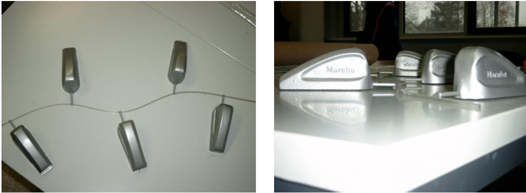
Abbildung 2.5: Ein "echter" Spline. Die Gewichte (und sie tragen ihren Namen zu Recht) fixieren das flexible Lineal an den Interpolationspunkten. Danke an Dr. M. Hollenhorst, der der Arbeitsgruppe Numerik seinen Spline überlassen hat.
