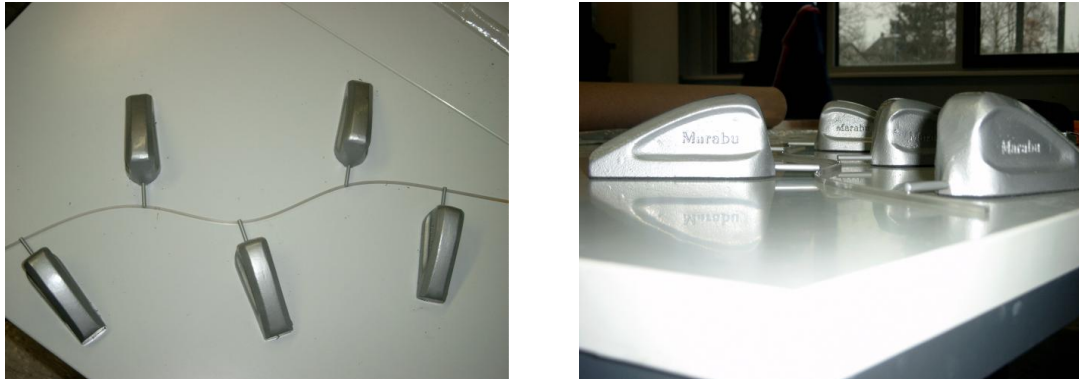
Abbildung 3.10: Ein “richtiger” Spline, das heißt, das Kurvenlineal, das dem mathematischen Objekt seinen Namen gegeben hat. Vielen Dank hierfür an Herrn Dr. Hollenhorst vom Hochschulrechenzentrum der JLU Gießen.
