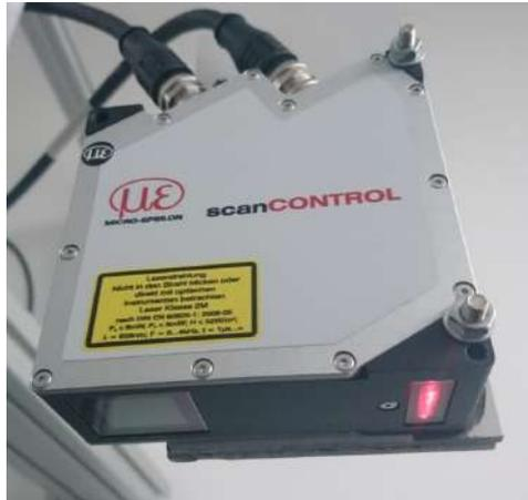
Abbildung 5.2: Der für die Experimente verwendete Laserscanner *Micro-Epsilon scanCONTROL 2600-100*
