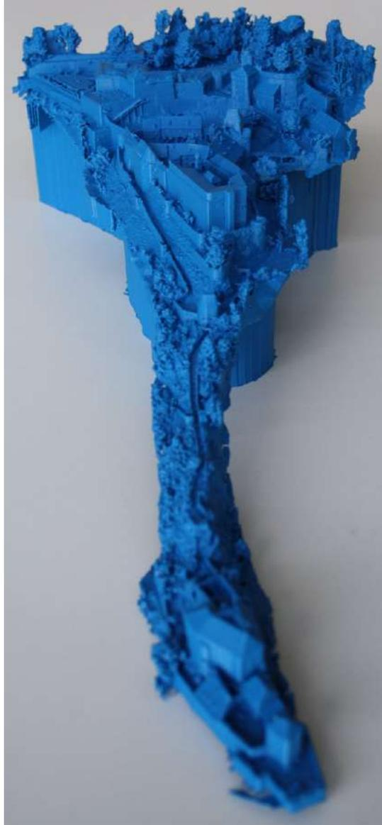
Abbildung 9.5: Gesamtansicht eines mittels FFF-Drucker erzeugten Drucks der Veste Oberhaus
