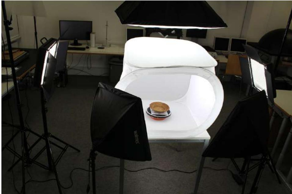
Abbildung 5.6: Aufbau zur photogrammetrischen Digitalisierung mit Drehteller
