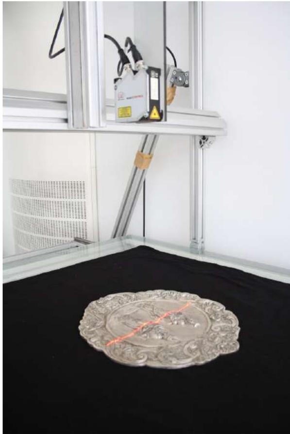
Abbildung 5.4: Das Objekt wird auf einem manuell verschiebbaren Tisch unter dem Laserscanner bewegt.
