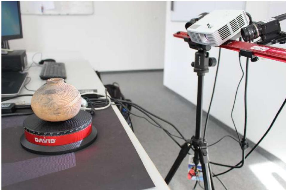
Abbildung 4.3: Einsatz eines Streifenlichtscanners zum Digitalisieren einer historischen Handgranate
