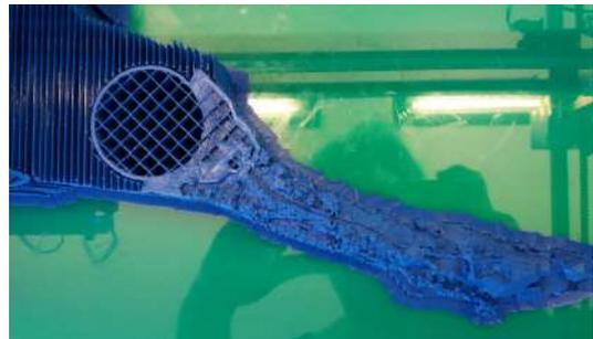
(b) Halbfertiges Modell mit Support- und Infill-Strukturen
