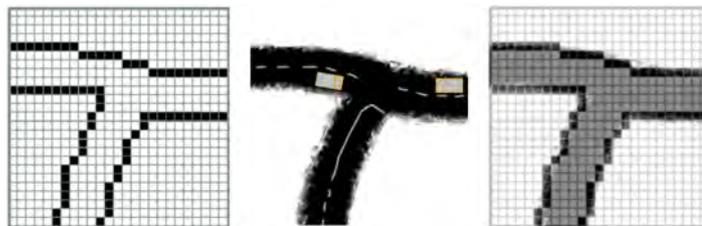
Abbildung 2.5: Kartenbasiertes Umfeldmodell: Das Occupancy Grid (links) kartiert den statischen Teil der Szenerie (Mitte). Rechts: Überlagerung von Szenerie und Grid.
