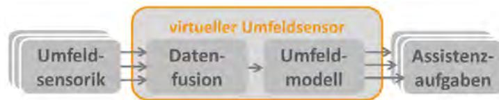
Abbildung 2.6: Ein virtueller Umfeldsensor entkoppelt Sensorik und Aufgaben.
