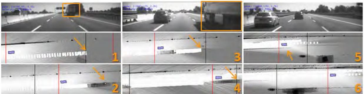
Abbildung 5.4: Zurückbleibende Artefakte bei Kartierung eines dynamischen Objekts.
