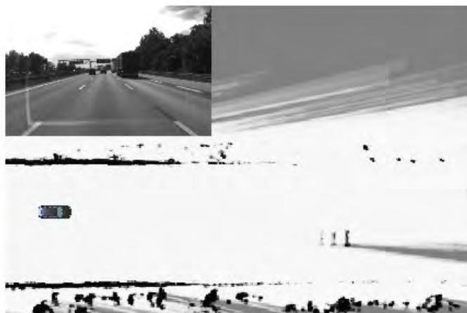
Abbildung 5.18: Eine in [27] präsentierte Szene auf der Autobahn, das Ergebnis wurde parallelisiert mit dem Grafikprozessor berechnet. Auffällig sind die eigentlich unerwünschten Artefakte durch den vorausfahrenden LKW.
