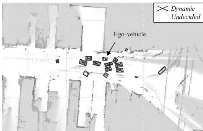
Abbildung 5.17: Das Occupancy Grid in [48] lässt gut den Einsatz eines 360-Grad-Laserscanners erkennen: die Freiraummodellierung erfasst auch die seitlichen Straßen vollständig. Ob es sich bei den grauen Spuren im rechten Teil um Fehler oder erwünschtes Verhalten handelt, bleibt aufgrund eines fehlenden Referenzbildes unklar.
