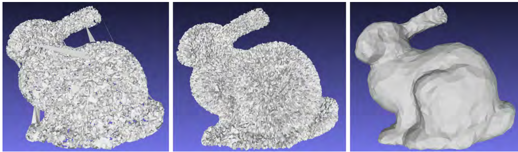
Abb. 10.22: Verrauschte Eingangsdaten: Triangulierung - explizit vs. implizit
