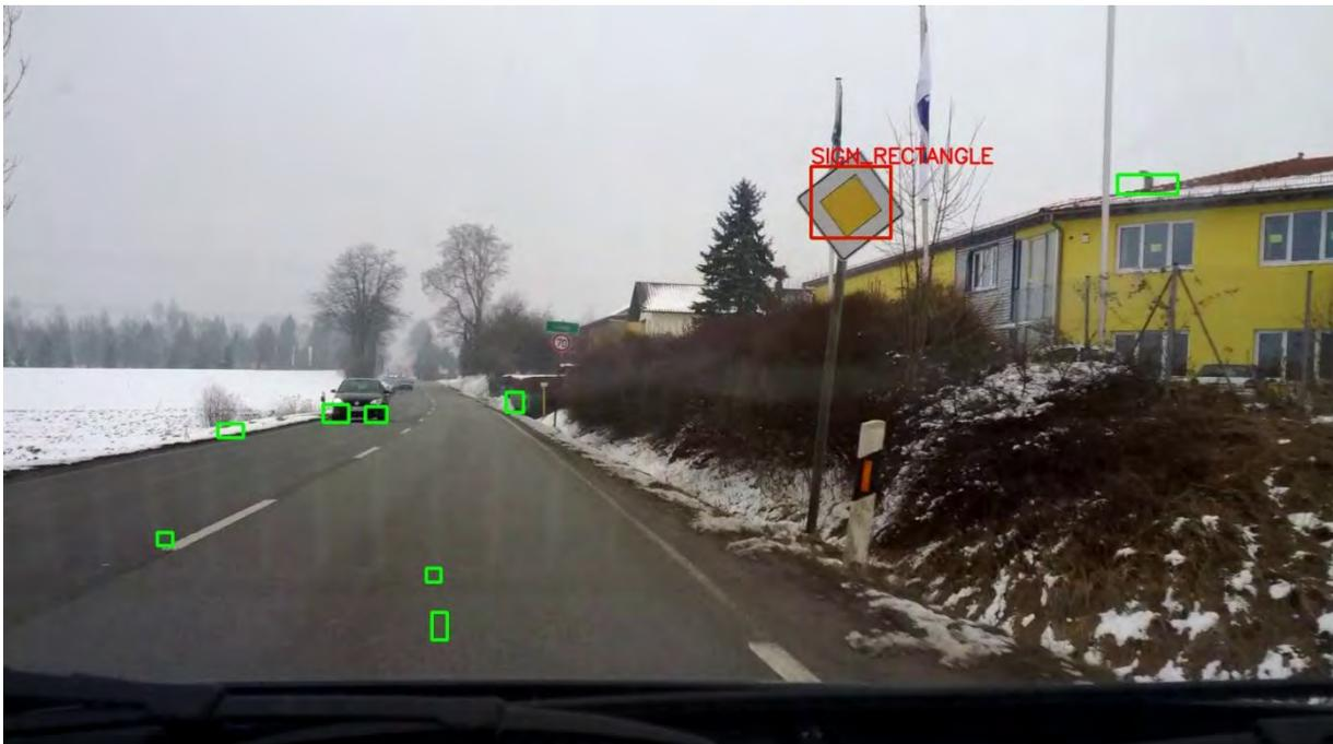
Abbildung 6-11: Erkennung eines viereckigen Schildes. Hier wurde kein Rotfilter gesetzt, darum wird das rote Schild nicht erkannt.
