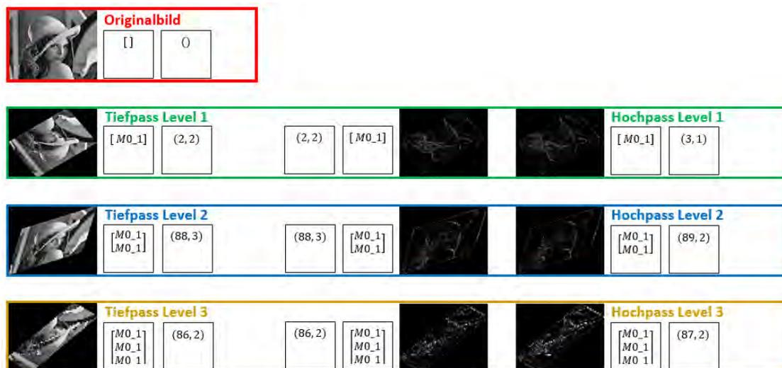
Abbildung 2.11: Das Testbild 'Lena' wird durch die Filterbank *Our Interpol M0\_1* zerlegt. Links sind die Tiefpass-Ergebnisse und rechts die Hochpass-Ergebnisse dargestellt. Neben jedem Filterergebnis steht seine Filterhistorie, welche in diesem Fall trivial ist. Zudem ist der Verschiebungsvektor für jeden Tiefpass und Hochpass im Cell-Array gespeichert. Eine Zeile entspricht jeweils einem Analyselevel. Für die Analyse wurde hier ein maximales Level von 3 gewählt.
