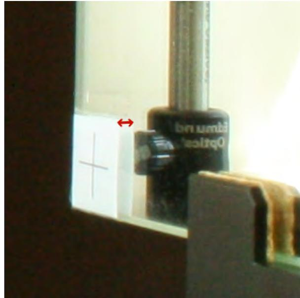
**Abbildung 10:** Blick auf eine Ecke eines handelsüblichen Spiegels: die Spiegelung tritt deutlich hinter der Oberfläche auf.
