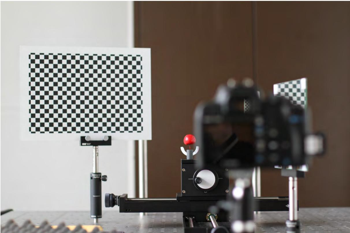
**Abbildung 9:** Aufnahme einer exemplarischen Szene: Zur Kamera rechts versetzt ist ein Spiegel so aufgebaut, dass er gerade noch ganz im Bild ist. Zur Linken wird ein Kalibrieremuster beobachtet. Das Objekt lässt sich durch Schrauben mikrometerweise verschieben.
