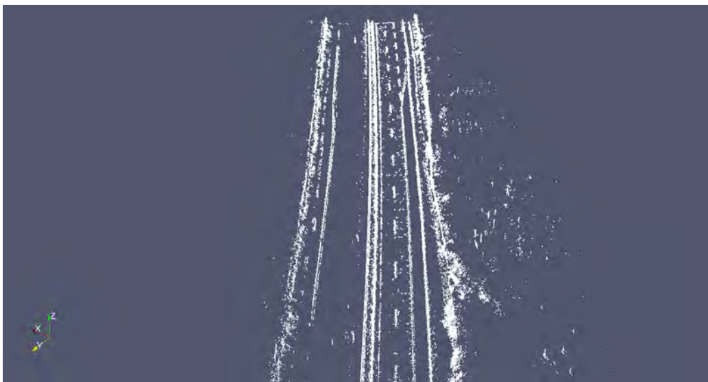
Abbildung 3.4: Mehrspurige Straße mit modifizierter Ausdünnung.
