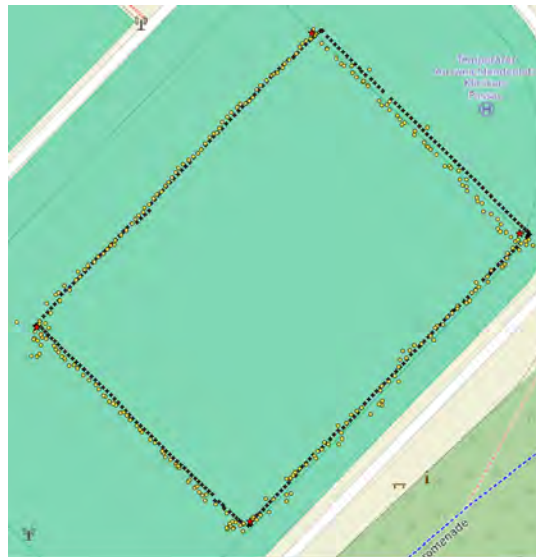
Abbildung 15: NaviLock Single Broadcast Aufzeichnungen im Vergleich mit Kinematic WTZR (schwarzes Plus) 1
