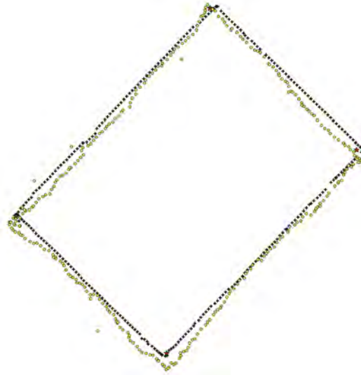
Abbildung 14: Android Wegpunkte als Rechteck entlang der Rasenkante im Vergleich mit NaviLock Kinematic WTZR
