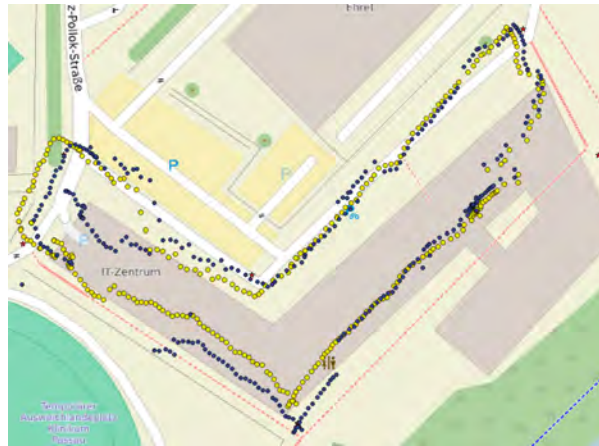
Abbildung 16: Android Wegpunkte (Gelb) um das ITZ Gebäude im Vergleich mit den korrigierten Punkten (Blau) 1
